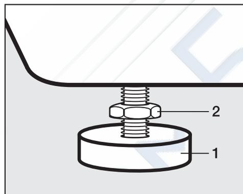
**⚠** Все четыре контргайки должны быть крепко привинчены к корпусу машины. Пожалуйста, проверьте даже те ножки, которые Вы не выворачивали при выравнивании. В противном случае существует опасность скольжения машины.
